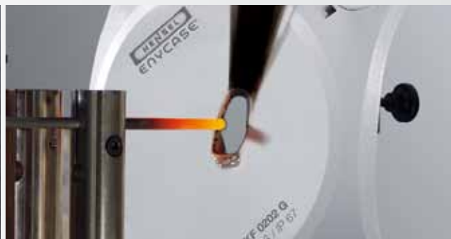
Brannatferd glødetrådtypest 960 °C Høy slagfasthet IK 09 (10 joule)
