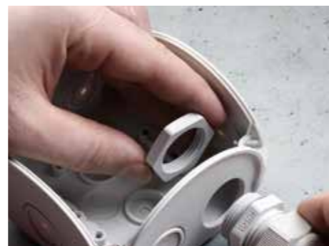
Tetningsmembraner eller utvidelsesring kan fjernes for kabelinnførings-nipler
