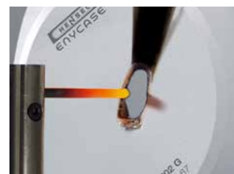
Glødetrådtestet iht. IEC 60695-2-11: Opptil 960 °C, flammehemmende og selvslukkende
