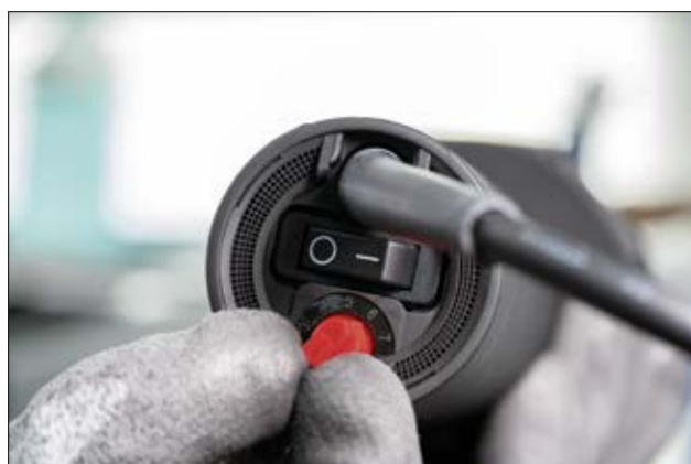
Justering H6100 driftstemperatur.
