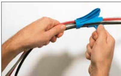
Legg inn en eller flere kabler i åpningen på HAT monteringsverktøy.
