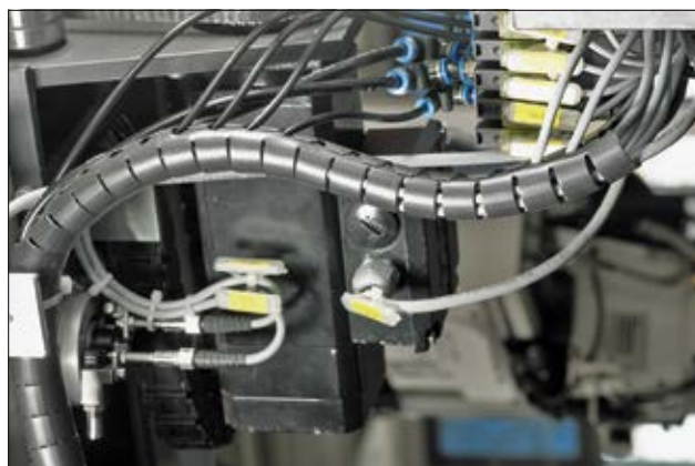
Bedre og mer effektiv kabelbeskyttelse med forgreningsmulighet hvor som helst langs kabelbeskyttelsen.
