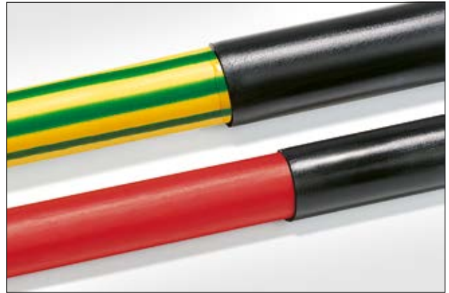
TA32 og TA42 er UL224 godkjente krympeslanger med lim. Finnes med krympeforhold 3:1 (TA32) og krympeforhold 4:1 (TA42).
