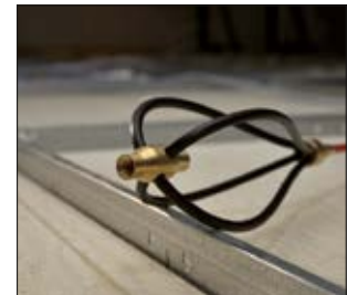
Vispen gjør at stengene glir lett over hindringer.
