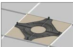
1. Plasser SpotClip-Plate i korrekt posisjon.
