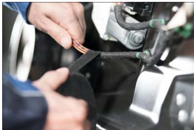
HelaTape Protect 250 er designet for kabelmatter og har meget høy temperaturresistens.
