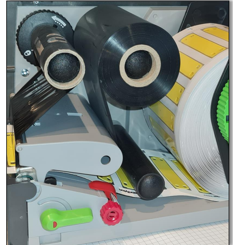
FIG. 2.2 For folie FTI-Y-110mm (18 003 39) skal selve rullen monteres i motsatt retning med den blanke siden ned mot merkene, mens mottaksrullen skal festes på samme måte som på forrige figur.
