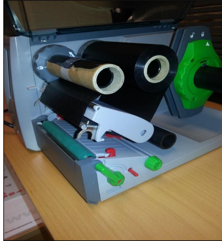
FIG. 2.1 Tre folien som vist på bildet med den matte siden ned. Fest folien med en tapebit i enden. Bruk riktig folie til valgt merkeprodukt.
