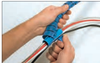
Plasser monteringsverktøyet i den ene enden av Helawrap.
