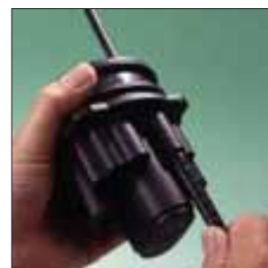
(4) Trekk både Cablelok™ og kabel tilbake i rett posisjon.
