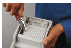
3 til 9 moduler: beskyttelse deksel kan skjæres ut
